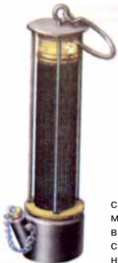
2 Шахтный светильник с предохранительной сеткой (лампа Х.Дэви) для шахт с повышенным содержанием взрывоопасных газов
